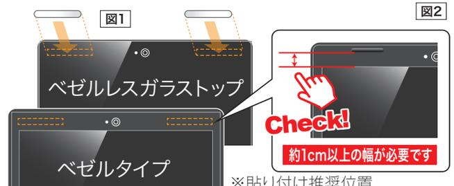
▲取り付けができない機種 取り付けられるベゼル部分の縦幅は約1cm以上必要となります。[図2] 薄型ベゼルなどには本製品は取り付けができません。十分にお使いの機種を確認してください。
