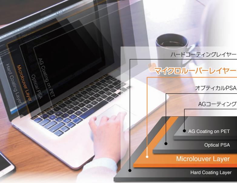
優れたマイクロルーバー層は高解像度ディスプレイの鮮明さを維持しながら、光りの方向を調整して確実な視野角の遮断と不要な乱反射を軽減します。液晶画面のキズを防止する厚さ0.5mmの3H硬度フィルムに、アンチグレアコーティングとハードコーティング・グレアフィルムの両面構造。
