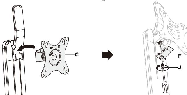
Cモニター固定部をアーム金具に取り付けてFモニター固定部取付部をJモニター固定部取付部ネジで固定します。
