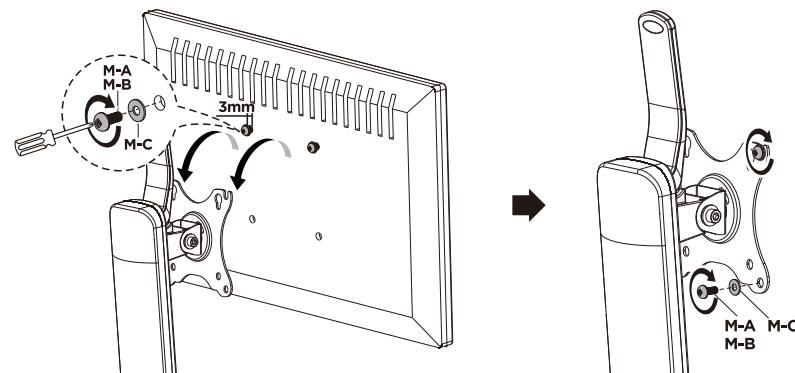
3.図のように先にモニター上部穴にモニター固定ネジ(M-A/M-B)とワッシャー(M-C)を使用して取り付けてください。
