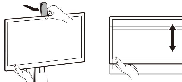
4.図のようにハンドルを手前に引きながら液晶モニターをご利用状況に合わせて上下に移動及び回転や角度を調整してご使用下さい。
