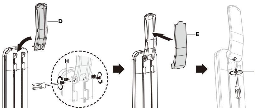
2.図のようにAモニターアーム部上部にDハンドルレバーをHハンドルレバーフォク付ネジを使い固定してください。ハンドルレバーにEハンドルカバーを取り付けてIハンドルカバーフォク付ネジで固定してください。
