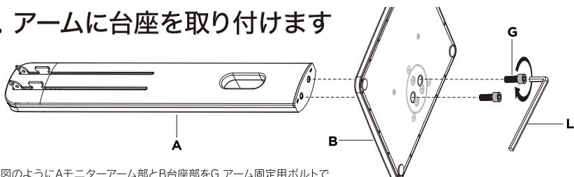
1.図のようにAモニターアーム部とB台座部をG アーム固定用ボルトで取り付けます。付属のL 6mm六角レンチをご使用ください。
