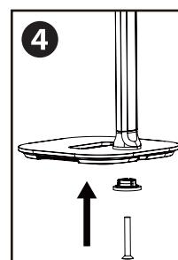
土台パーツにアームをセットして、裏側から固定パーツを取り付けて、六角レンチでネジを閉めて固定します。
