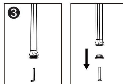
土台パーツ裏面に収納されている六角レンチをつかって、アーム下部のネジと固定パーツを取り外してください。
