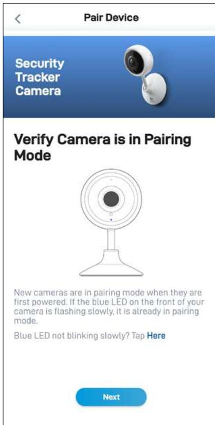
カメラのLEDインジケータが表示のように青色でゆっくり点滅しているか確認します。点滅していれば、カメラは既にペアリングモード(すなわち、カメラのホットスポットが一時的に起動している状態)になっており、ペアリング準備が整っています。[次へ]ボタンをタップします。
