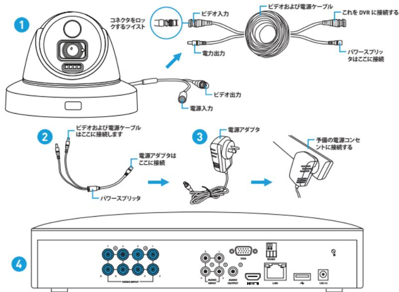
カメラ1台パックの場合、付属の電源アダプタを、ビデオおよび電源ケーブルの電源入力に直接つなぎます。
