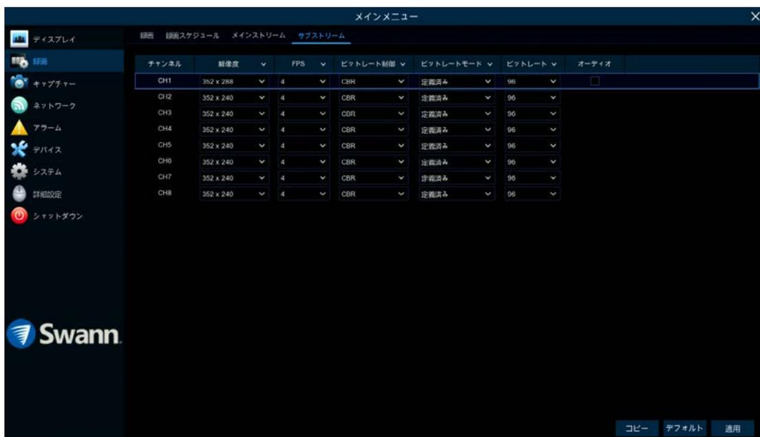
これにより、Swann セキュリティ アプリを使用して、モバイル デバイスにビデオをストリーミングする方法を制御できます。DVR からライブビデオをストリーミングする問題がある場合は、フレーム レート、ビットレート モード、ビットレート制御を変更できます。
