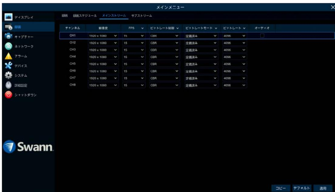
ここで利用できる機能によって、接続済みの各カメラの解像度、フレームレート、ビットレート制御、およびビットレートモードが変更できます。デフォルトでは、録画の解像度は備え付けられたカメラの機能に合うように自動的に選択されます。
