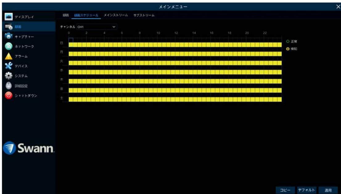
既定では、接続されている各カメラに対して、週 24 時間 7 日の検出スケジュールが有効になっています。スケジュールを変更することができ、必要に応じて各カメラのスケジュールを異なることができます。スケジュールは、イベントの種類を表す色分けされています。
