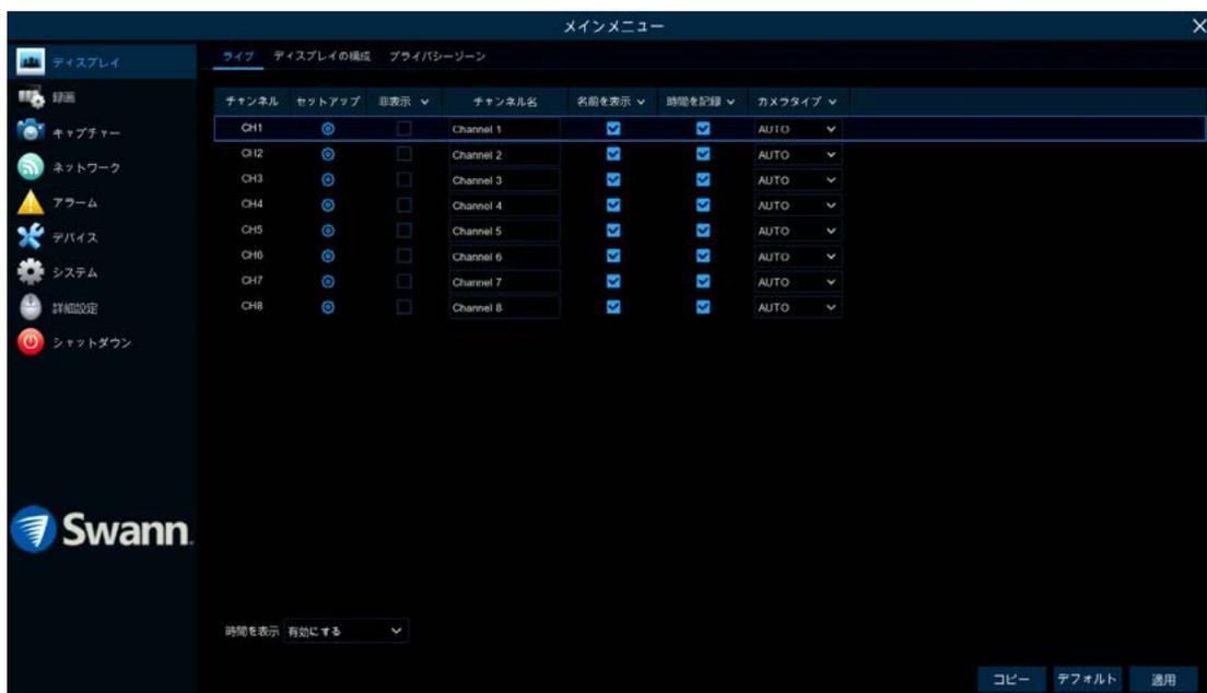
利用可能な設定オプションを使用すると、輝度やコントラストなどの画像設定を調整する機能だけでなく、各カメラに設置場所に関連する名前を付けることもできます。また、隠しモードを有効にして、ライブ表示モードでカメラの画像を非表示にすることもできます。
