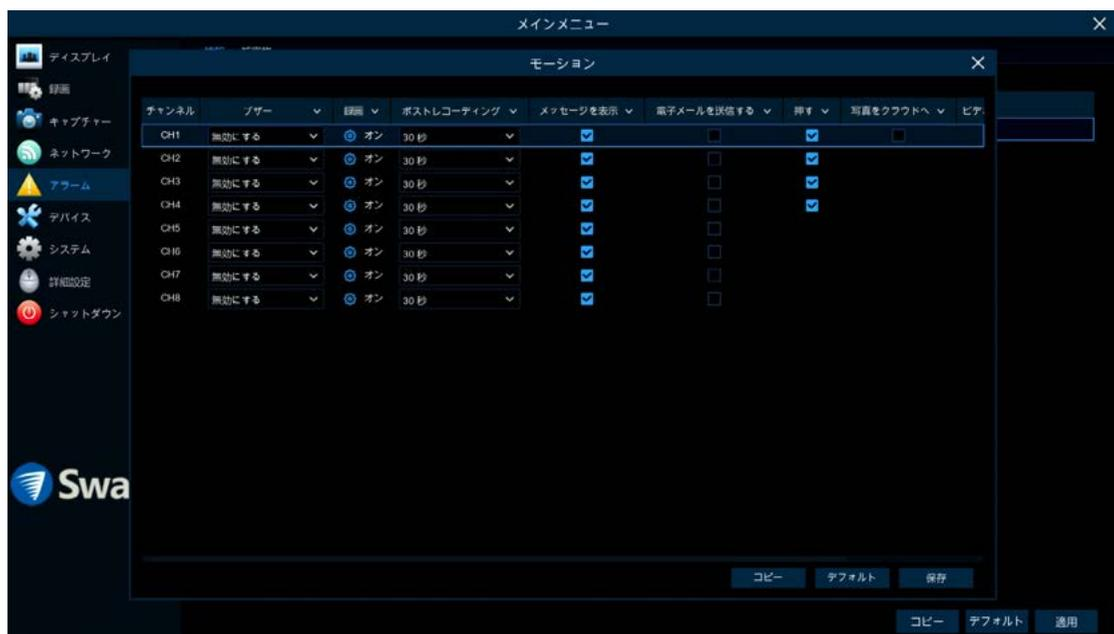
**ブザー:** モーションが検知されたらDVRのブザーを有効にして、あらかじめ定めておいた時間だけ警告音を発するように設定しておくことができます。
