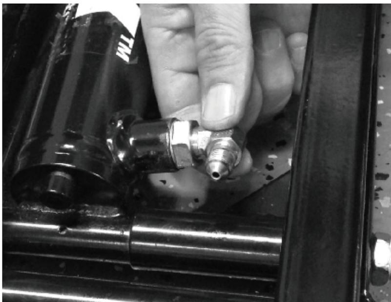
3. ねじ山継手側の向きを、上方からアクセスできるような具合に調整します。
