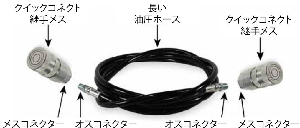
5. それぞれの長い油圧ホースの端部に取り付けられたクイックコネクト継手メスを、パワーユニットと短い油圧ホースのクイックコネクト継手オスに接続します。
