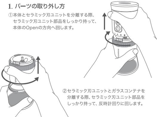
② セラミック刃ユニットとガラスコンテナを分離する際、セラミック刃ユニット部品をしっかりと持って、反時計回りに回します。
