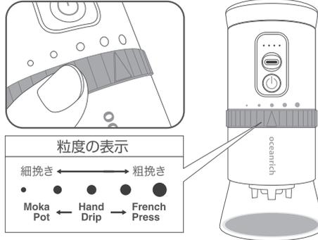
⚠ ホッパーに豆が残ったまま粒度調整リングを調整すると、豆が詰まり故障の原因になります。その場合は電源を入れ、完全に豆を落としてからご使用ください。
