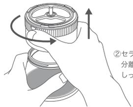
⚠ ホッパーおよびセラミック刃ユニットを分解しないでください。セラミック刃の回転軸がずれ、故障の原因になります。
