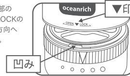
⚠ 本体、セラミック刃ユニット及びガラスコンテナはしっかりと閉めてご使用ください。動作中に各パーツが分離し、粉が外に出てしまう恐れがあります。
