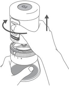
②セラミック刃ユニットとガラスコンテナを分離する際、セラミック刃ユニット部品をしっかりと持ち、反時計回りに回します。
