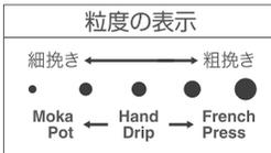
⚠ ホッパーに豆が残ったまま粒度調整リングを調整すると、豆が詰まり故障の原因になります。その場合は電源を入れ、完全に豆を落としてからご使用ください。
