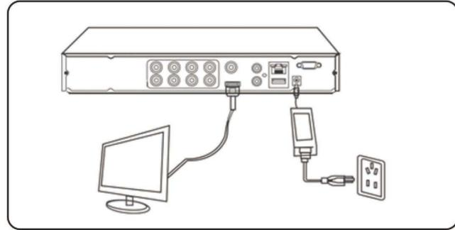
Step1 : 電源を入れ、DVRをHDMI、またはVGAケーブルでモニターに接続します。
