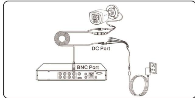
Step2 : カメラをBNCケーブルでDVRに接続します。
