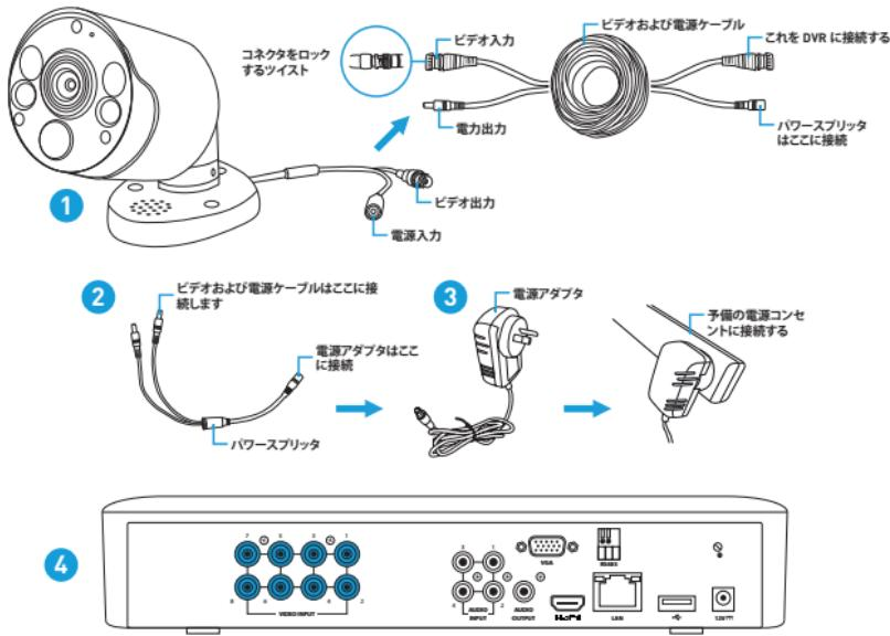
カメラ1台パックの場合、付属の電源アダプタを、ビデオおよび電源ケーブルの電源入力に直接つなぎます。
